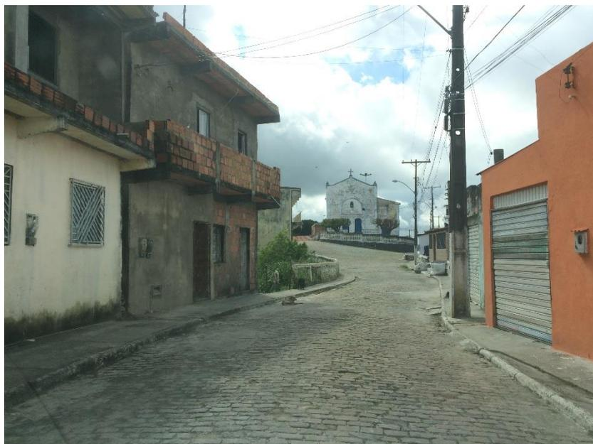
**Figura 34:** Exemplo de rua pavimentada em paralelepípedo
